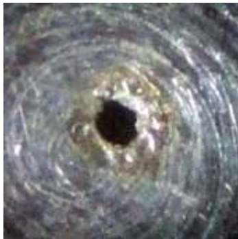
Orificio acero inoxidable Baja calidad - 0,15 mm.
